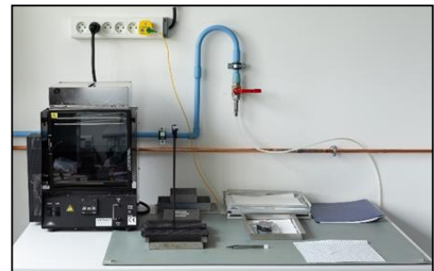
Poste de tests grosses fuites
