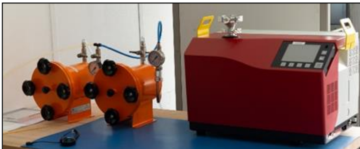
Poste de mesures fines fuites
