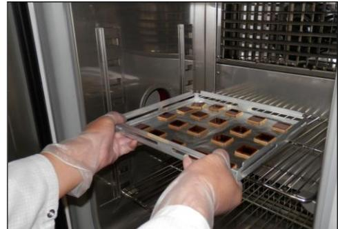
*Mise en place des composants dans l'enceinte climatique*
